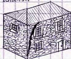
Tipica lesione da cedimento in fondazione
